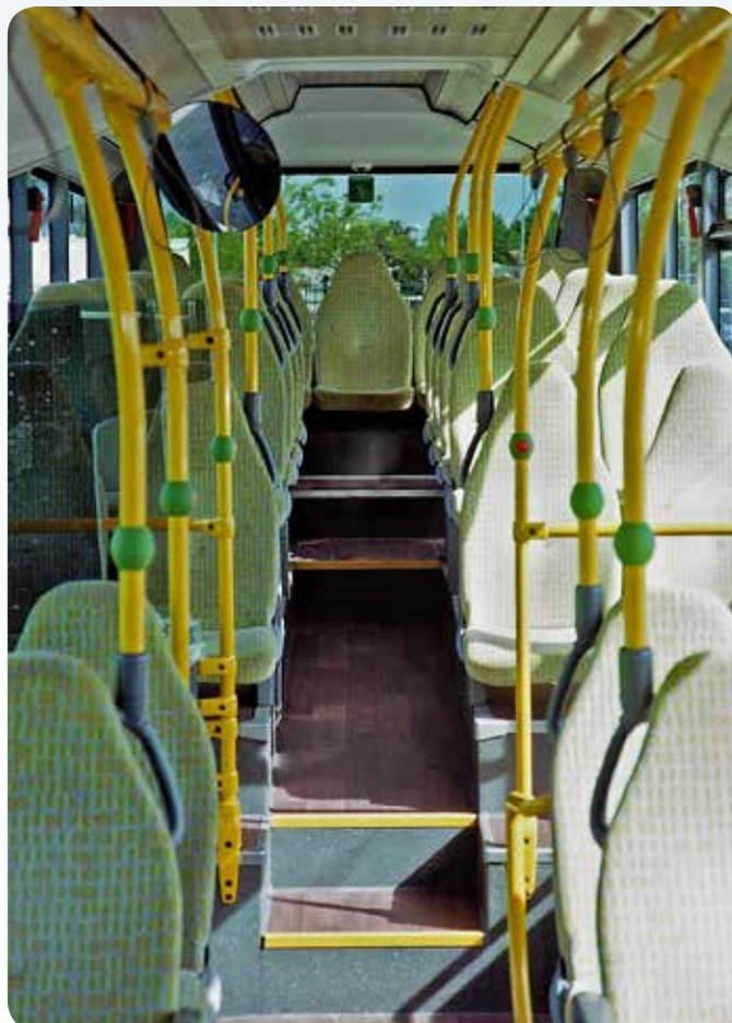
Low-Entry-Bus, niederfluriger vorderer Bereich, hochfluriger Heckbereich (Beispiel)
