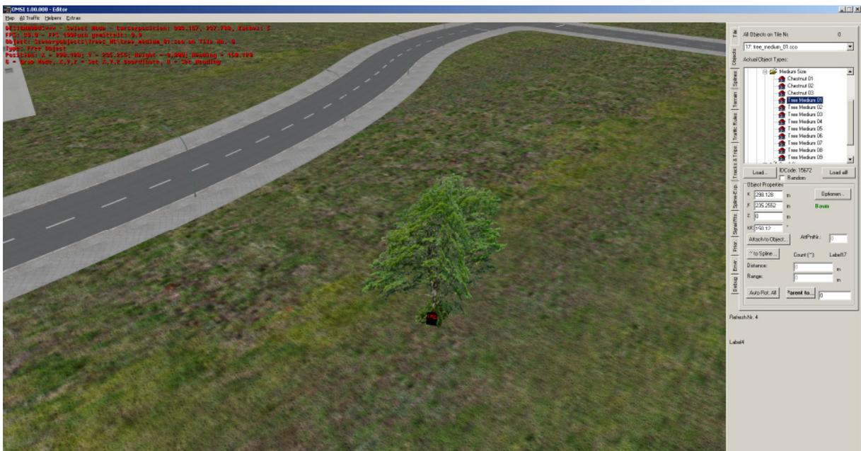
In diesem Fall ist das eigentliche Objekt nur ein kleiner Würfel am Fuße des Baumes, welcher ausgewählt, bewegt, rotiert und gelöscht werden kann. Der Baum selbst kann *nicht* ausgewählt werden.
