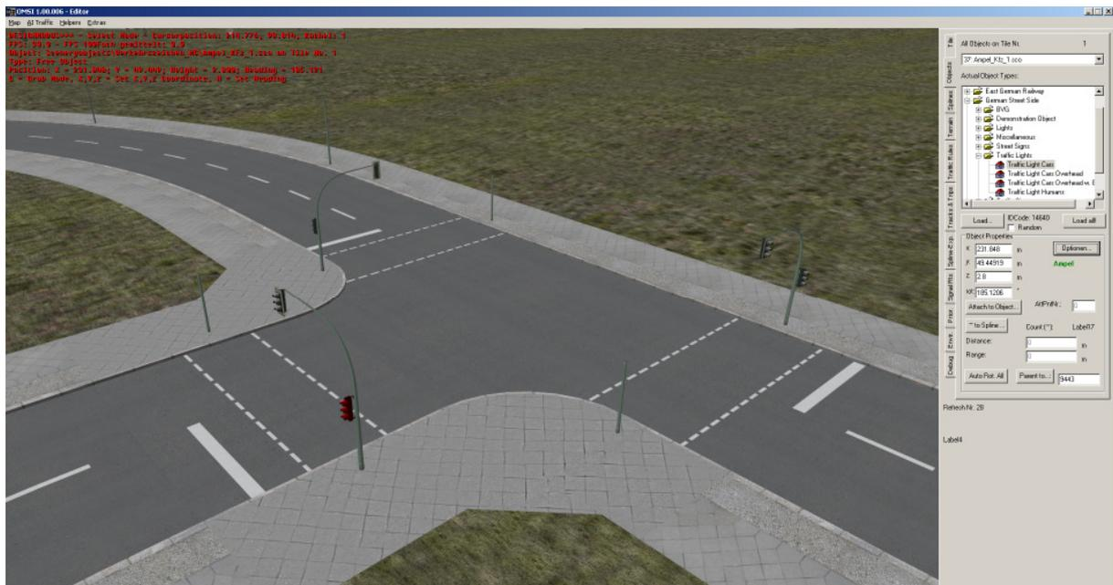
Schließlich sollen noch die Fußgängerampeln platziert werden. Diese werden wie folgt angeordnet und erhalten eine „2“ für die Furt über der Einmündung / parallel zur Haupttrichtung bzw. eine „3“ für die beiden Furten über der Haupttrichtung, die parallel zur Einmündung verlaufen. Die Höhe ist wieder 2.8:
