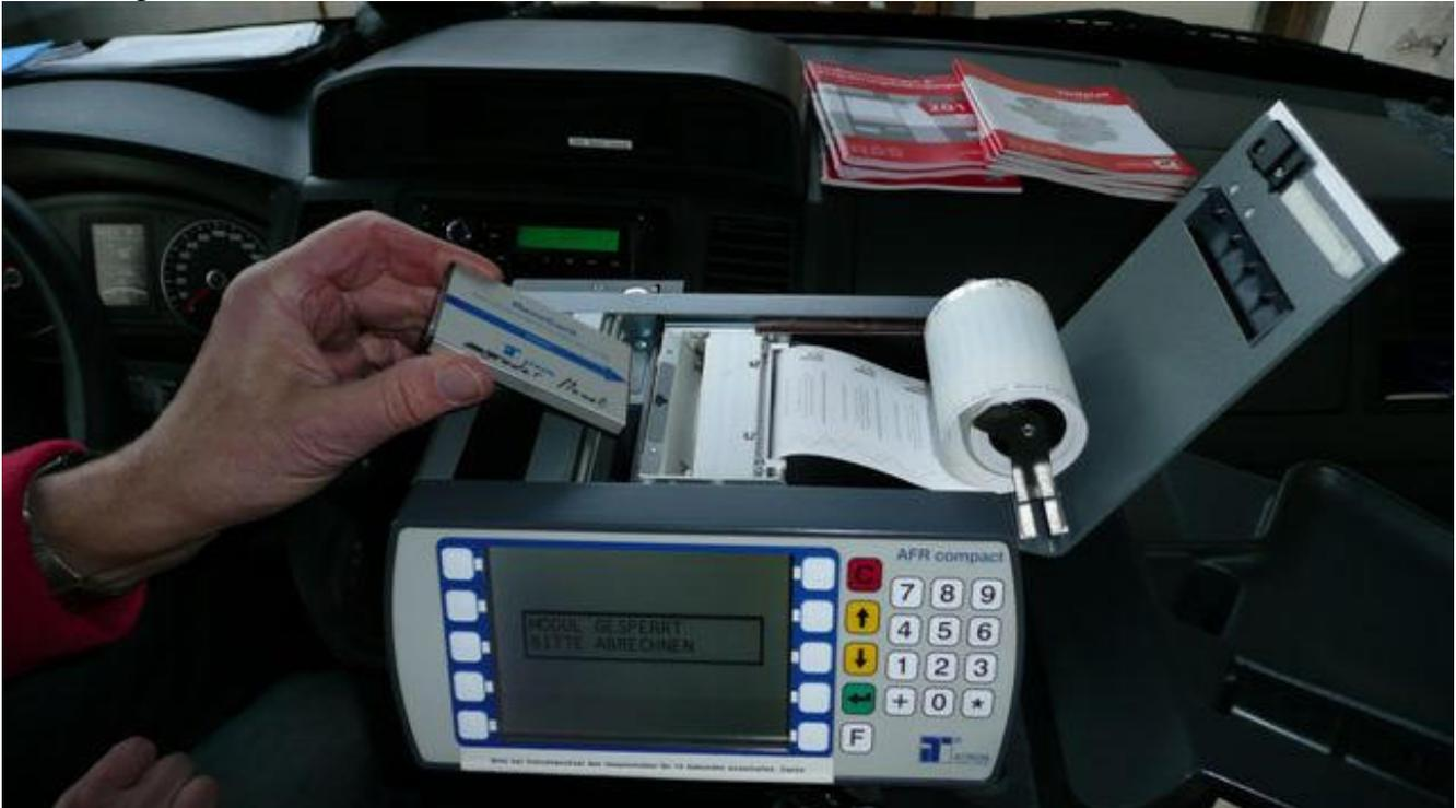
Das Thermopapier wird in die Papierhalter hinter dem Rollendruckwerk eingesetzt. Hierzu sind die beiden Laschen auseinanderzudrücken und das Papier so einzusetzen, dass die Kunststoffrolle im Kern der Papierrolle einschnappt. Das thermosensitive Papier ist so einzusetzen, dass das lose Ende an der Seite zum Drucker hin von unten herauskommt. Um einen einwandfreien Betrieb zu gewährleisten, ist beim Einfädeln des Papiers folgendes zu beachten:
